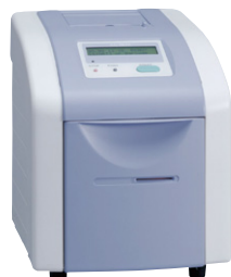
糖尿病の血液検査項目の一つであるグリコヘモグロビンA1c測定装置A1c iGear K
