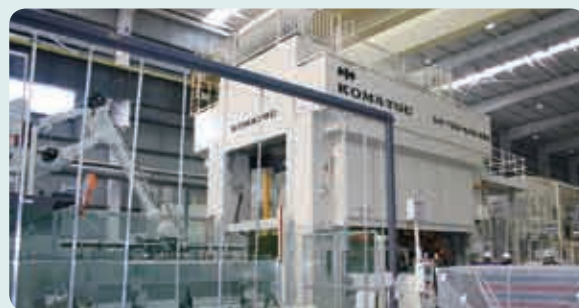
ブランキング加工の設備(写真は中国・天津の設備)
