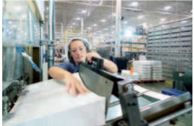
Viimeinen ojennus pinkalle esipainettuja kartonkiaihioita, ennenkuin ne taipuvat jäätelöpakkauksiksi Huhtamaki Systems -muotoilukoneessa.
