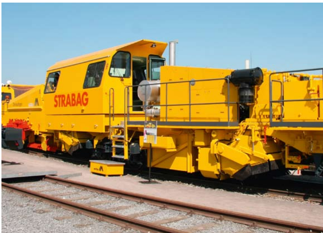
DER R24 SCHOTTERPFLUG VERTEILT UND PLANIERT SCHOTTER MIT 2 KM/H
